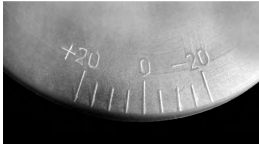
Winkelskala auf dem Schaufelfuß Angle scale on the blade base Graduation d'angle sur le pied de pale Угловая шкала на основании лопатки
